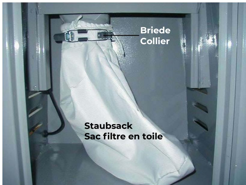
*La poussière de ponçage est récupérée dans le sac filtre en toile, à l'intérieur du socle. Ce sac filtre est attaché à l'aide d'un collier.*
