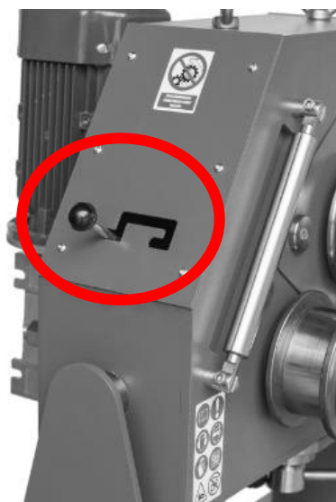
Fig. 12. Poignée pour activer l'entraînement du galet supérieur : position pour engager l'entraînement du galet supérieur
