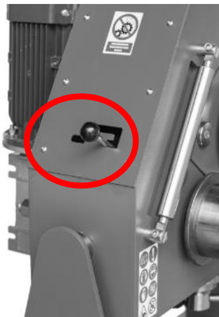
Fig. 13. Poignée pour désactiver l'entraînement du galet supérieur : position pour désengager le galet supérieur
