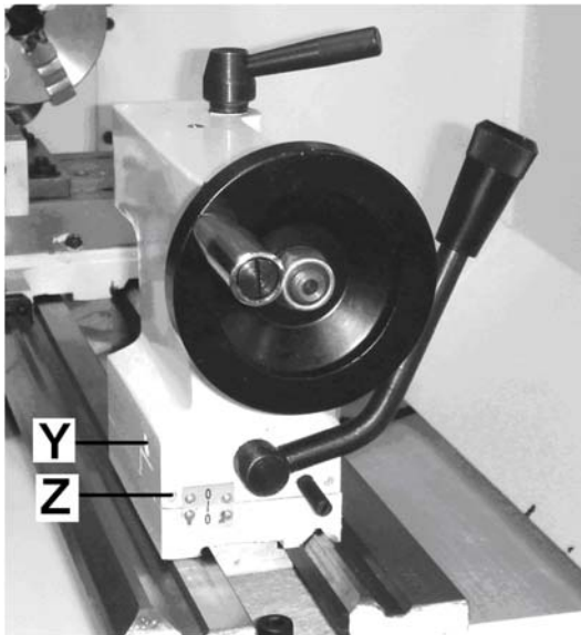
Abb. 8-3: Kegeldrehen zwischen Spitzen
