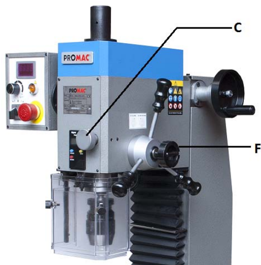
Abb. 8-2: Aktivieren des Handrads für Feinjustierung
