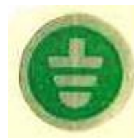
Figure 9 : notification de mise à la terre
