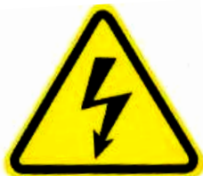
Abb. 4 Warnt den Anwender vor gefährlicher elektrischer Spannung; darf nur von dafür geschulten Personen geöffnet werden
