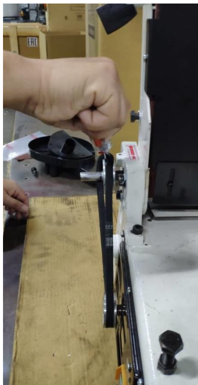
3. Tirez la courroie afin de la placer dans la gorge de la poulie
