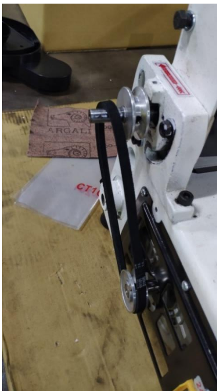
1. Montieren Sie den Antriebsriemen auf die Motorriemenscheibe.
