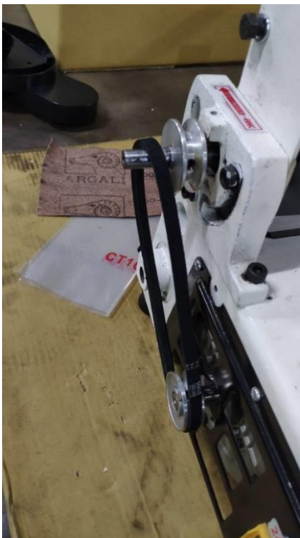
1. Monter la courroie sur la poulie moteur
