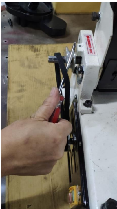
2. Anhand eines Schraubenziehers den Riemen bis zur zweiten Riemenscheibe spannen.
