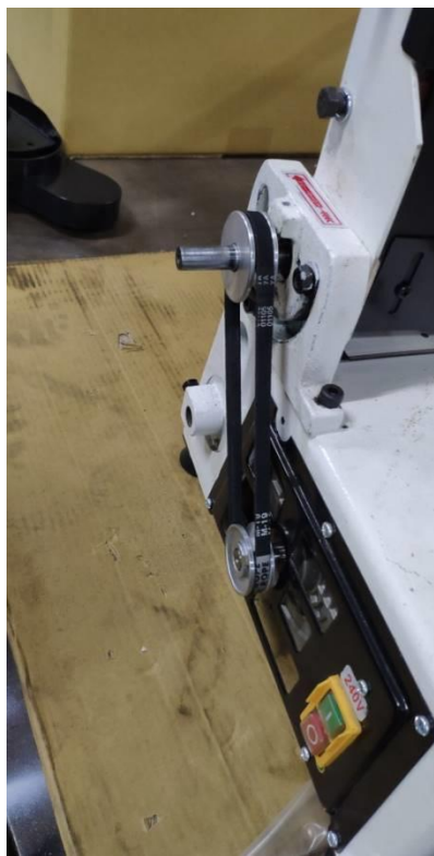
4. La forte tension de la courroie entrainera parfaitement la bande abrasive
