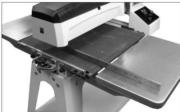
Abb. 6-4: Ausrichten der Verlängerungstische
