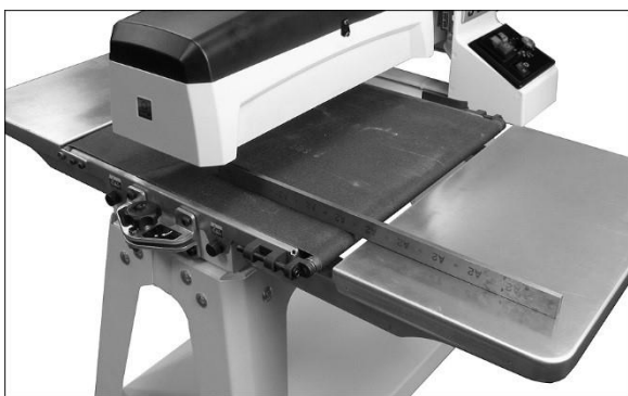
Figure 6-4: Alignement des extensions de table
