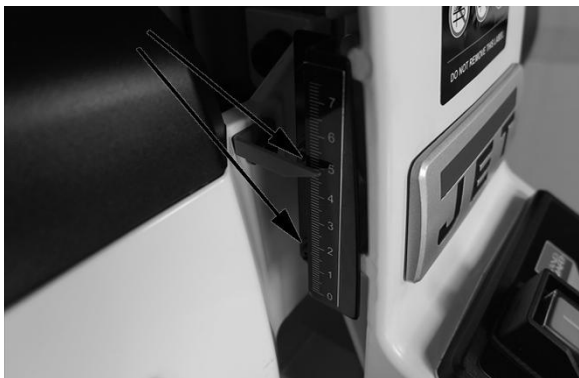
Figure 8-1: Réglage de l'échelle de profondeur
