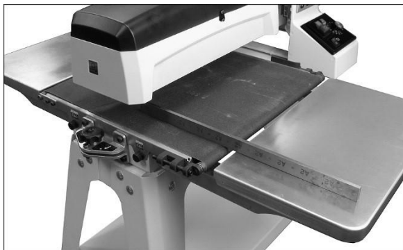
Abb. 6-4: Ausrichten der Verlängerungstische
