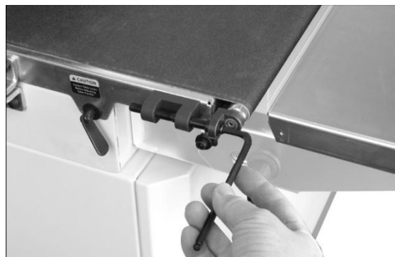
Figure 8-2: Réglage tension de courroie
