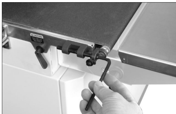
Figure 8-2: Réglage tension de courroie
