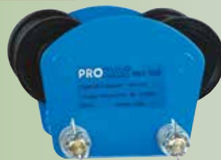
992-100 Chariot porte-palan pour palans électriques Cap. 1'000 kg, 68 - 110mm se monte sur IPN de : 125x75x5.5 à 250x125x7.5mm
