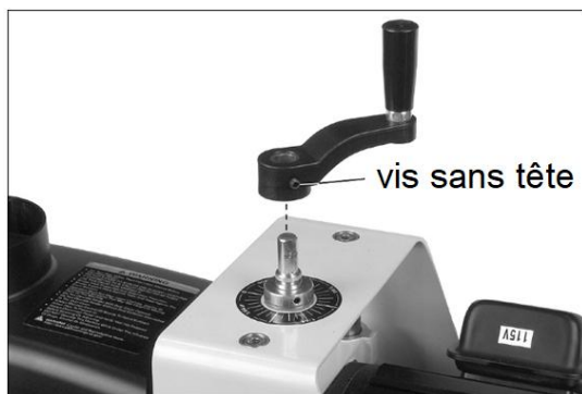
Figure 6-1: installation de la poignée
